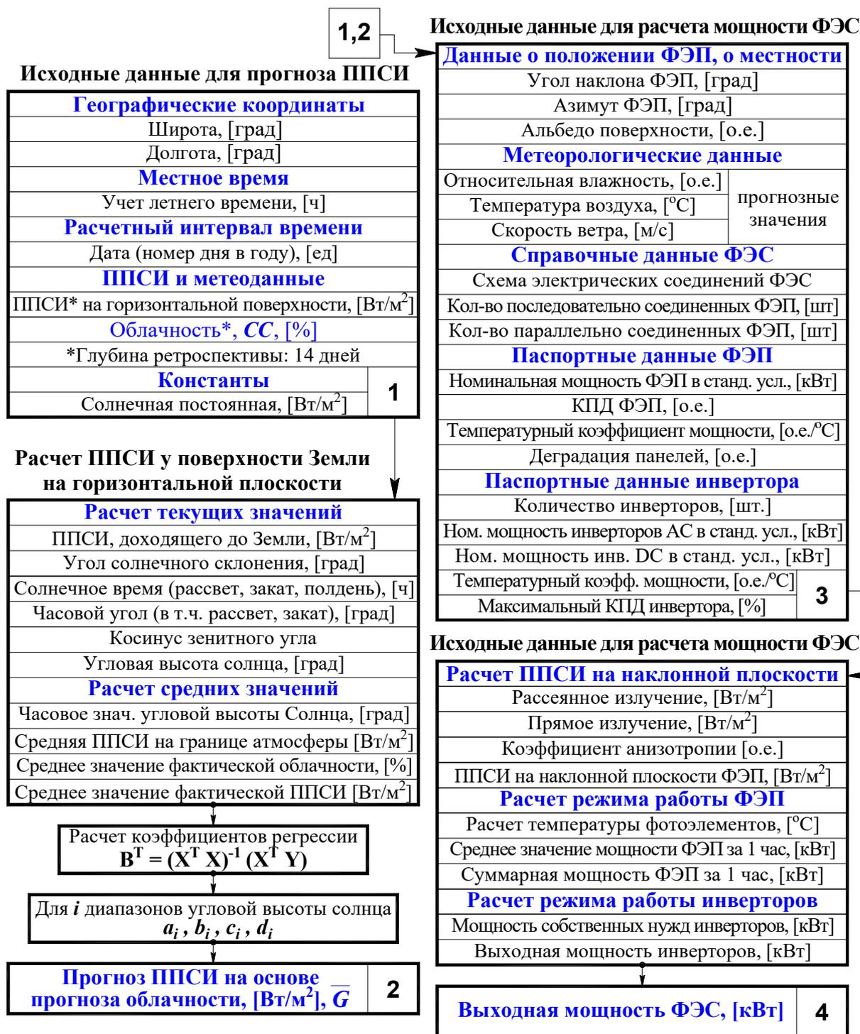
Рисунок 5 – Обобщенная схема краткосрочного прогнозирования генерации ФЭС
