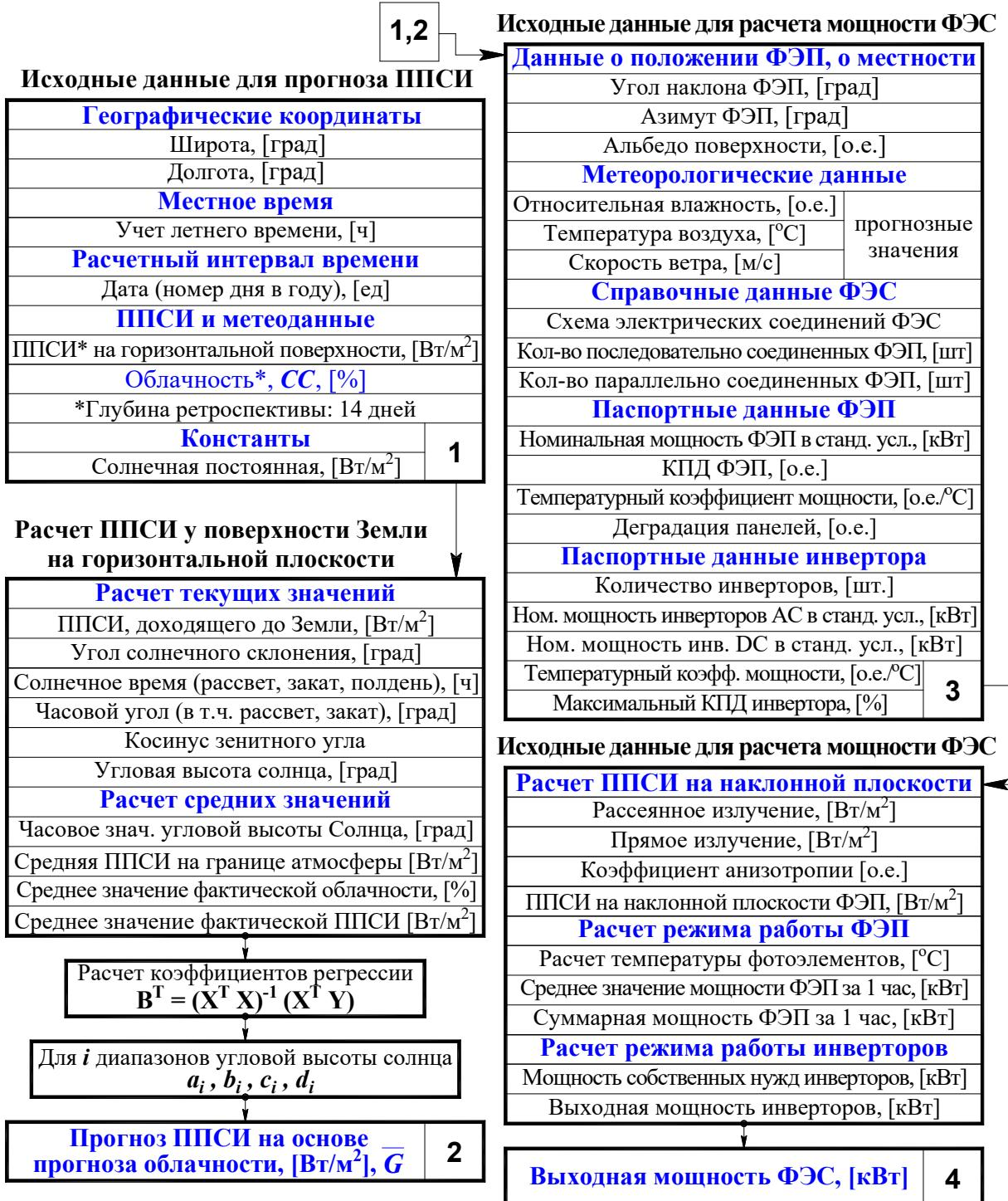
Рисунок 5 – Обобщенная схема краткосрочного прогнозирования генерации ФЭС
