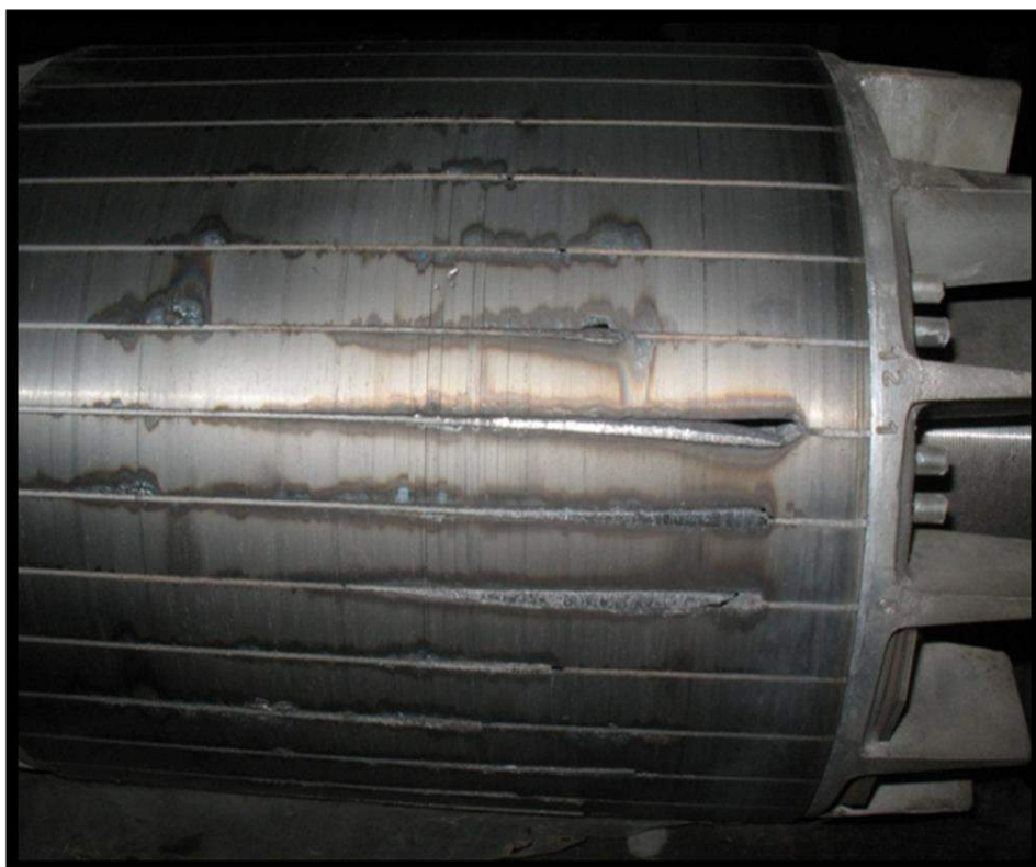
Рисунок 1.7 - Фотография ротора АД НВА-55 с множественными повреждениями стержней беличьей клетки, эксплуатировавшегося на электровозе типа ЭП1М с конденсаторной системой питания АД
