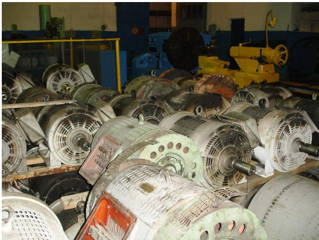
Рисунок 1.5 - Отказавшие АД НВА-55 в локомотиворемонтном депо
