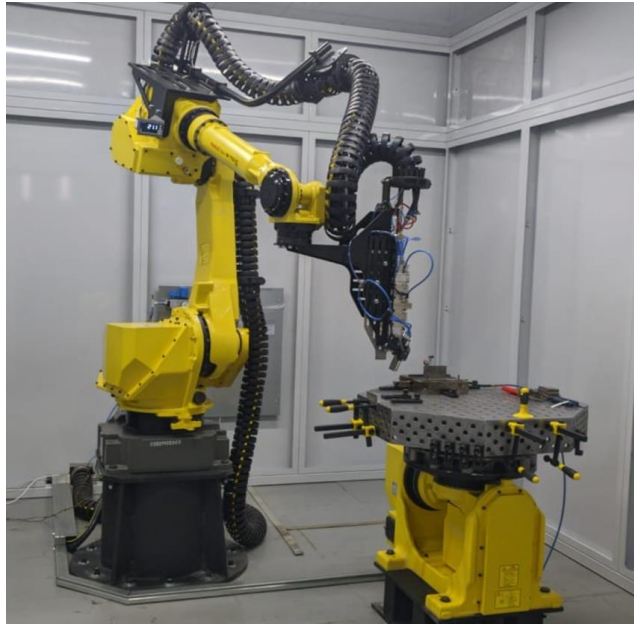
Рисунок 6.1 – Наплавочно-сварочный комплекс, оснащенный многокоординатной «рукой» и волоконным лазером АЛТК «Сибирь»
