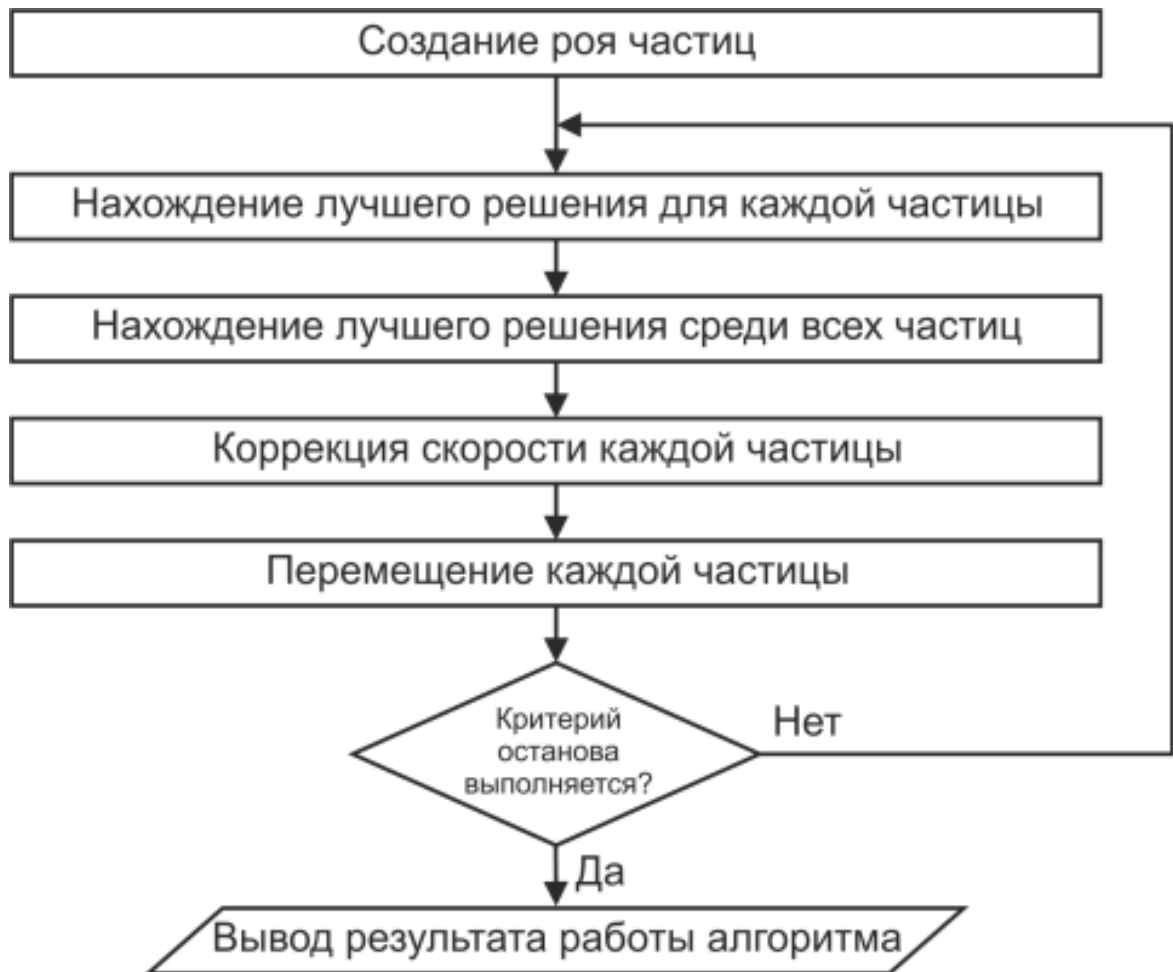
Рисунок 3.1 – Алгоритм поиска оптимальной формы управляющего воздействия методом роя частиц
