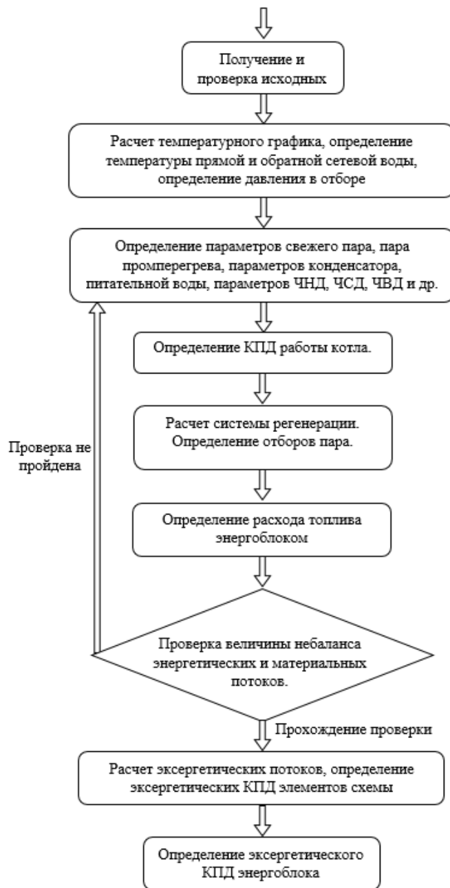
Рисунок 2.4 – Алгоритм расчета тепловой схемы энергоблока
