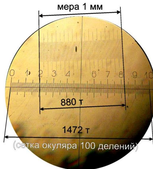
Рисунок 2.12 - Фотография определения масштаба окулярной сетки с образцовой мерой (длиной 1 мм). Коэффициент пересчета  $K = 1472 \text{ т} / 880 \text{ т} = 1,67$
