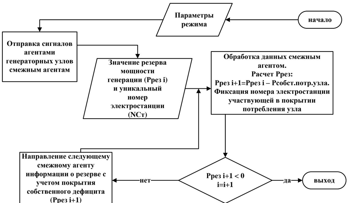
Рисунок 3.6 – Блок-схема поиска сечений деления при адаптивном делении ЭЭС
