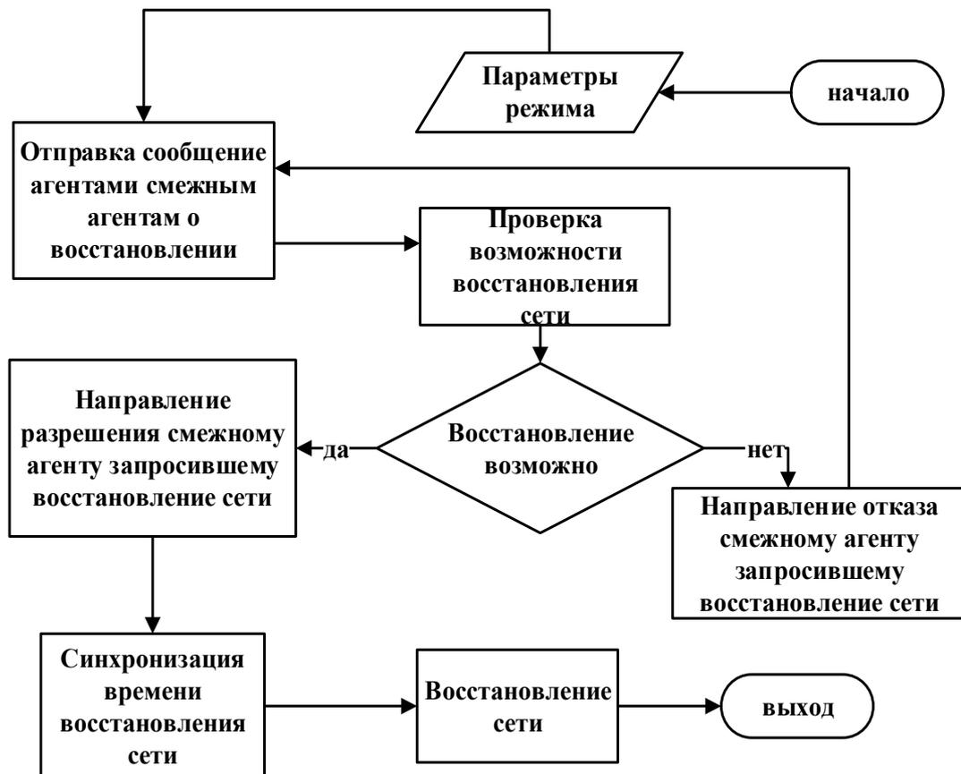
Рисунок 3.8 – Блок-схема алгоритма восстановления сети
