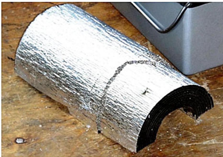
Рисунок 4.7 – Внешний вид одного из образцов изоляции ввода 110 кВ
