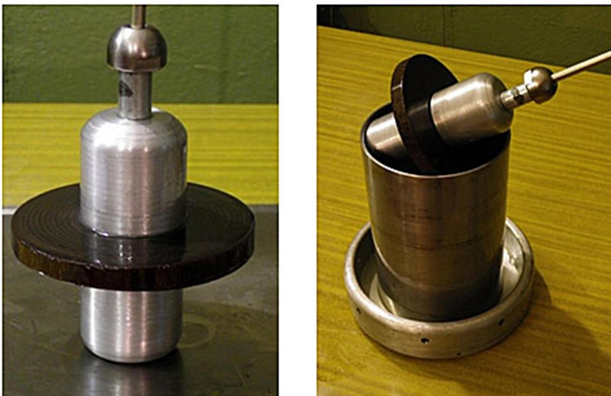
Рисунок 4.9 – Электродная система с образцом RIP изоляции
