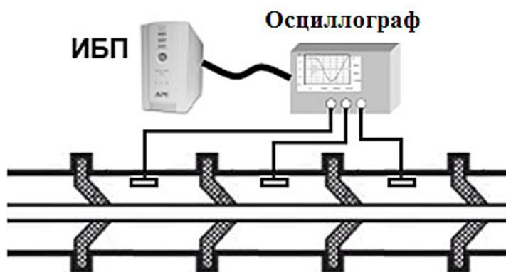
Рисунок 2.11 – Схема подключения регистрирующей аппаратуры к автономному источнику питания
