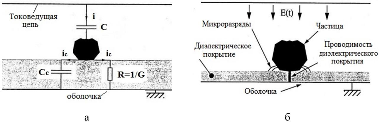
Рисунок 1.14 – Зарядка частицы через диэлектрическое покрытие (а)
