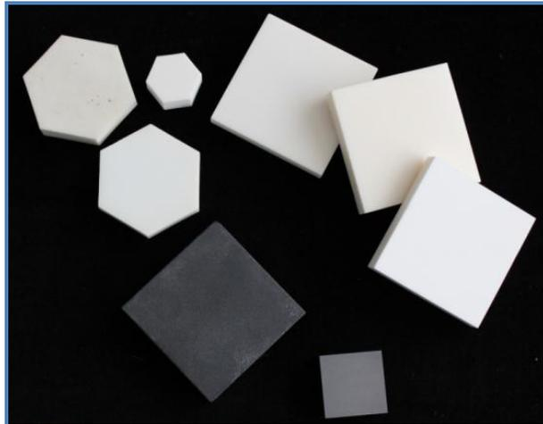
Рисунок 5.5 – Плоская и радиусная плитка из карбида бора и вакуумной керамики
