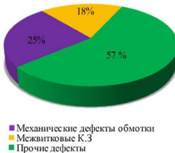
Рисунок 1.6 - Диаграмма распределения дефектов в процентном отношении для трансформаторного оборудования напряжения 10/0,4кВ по филиалу ОАО «Тюменьэнерго» Тюменских распределительных сетей за период 2008-2012 г.г.
