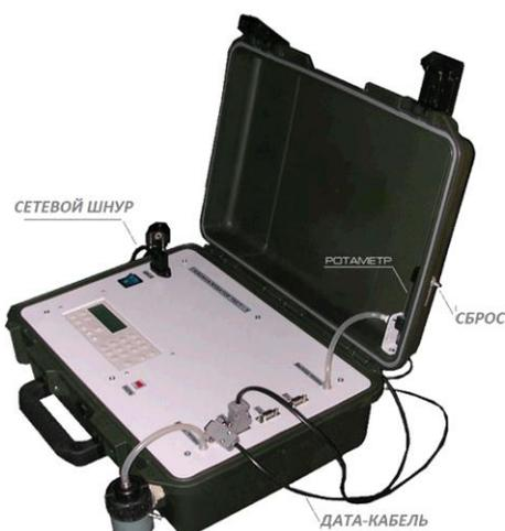
Рисунок 2.6 - Газоанализатор ТЕСТ-1
