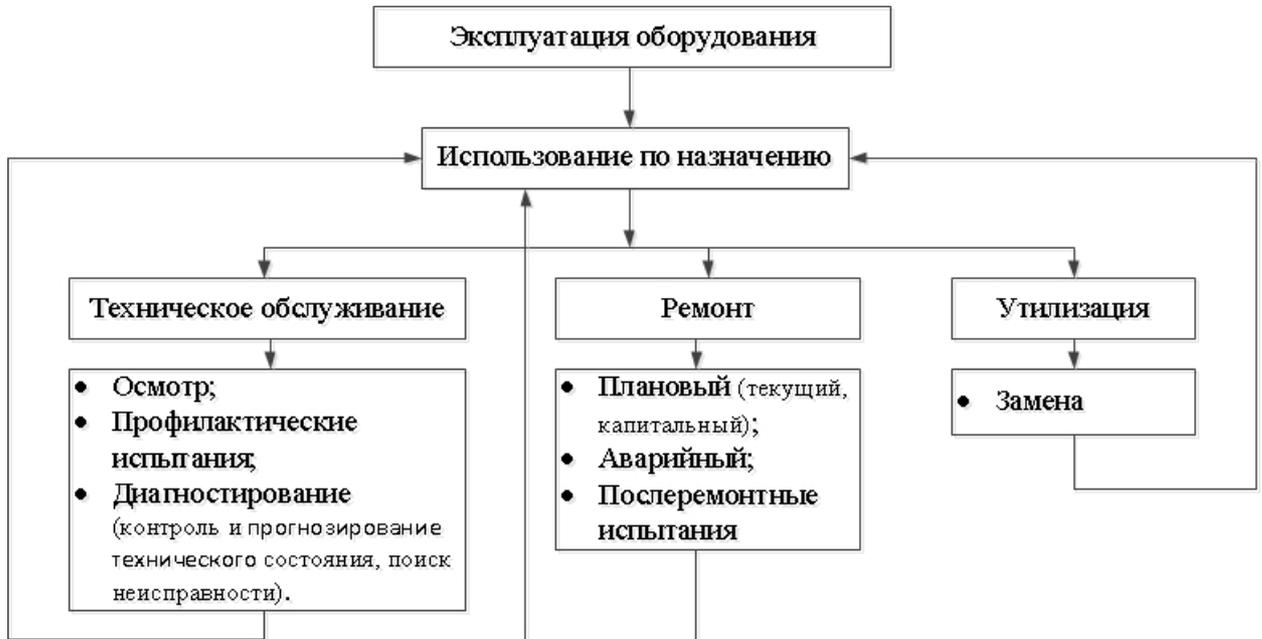
Рисунок 1.3 – Этапы эксплуатации оборудования электрических сетей.
