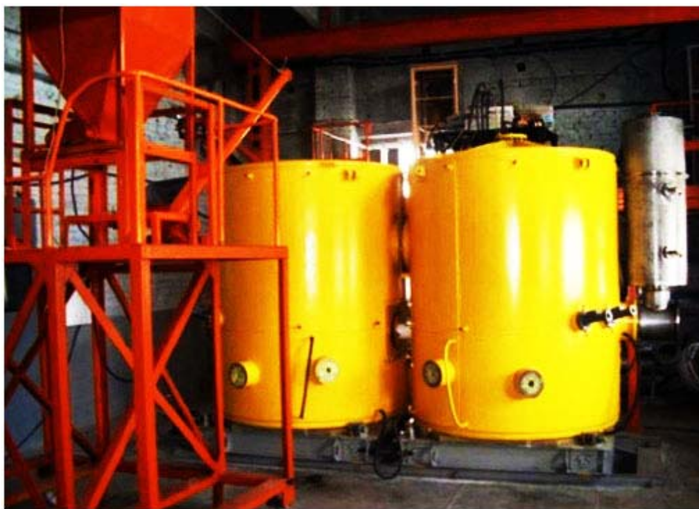
Рисунок 1.18 – Плазмохимический реактор для утилизации токсичных отходов мощностью 500 кВт
