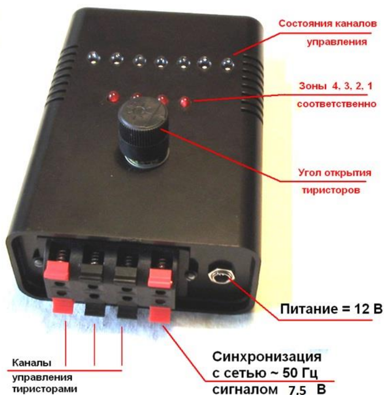
Рисунок 5.4 – Микропроцессорный блок управления тиристорами
