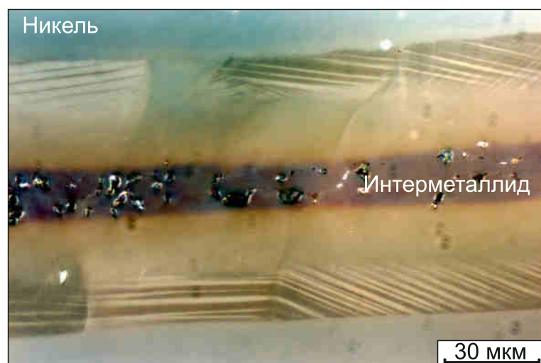
Рисунок 6.5 – Строение интерметаллидных прослоек композитов «никель – интерметаллид никеля», полученных методом искрового пламенного спекания: а – давление 10 МПа, б – 20 МПа, в – 30 МПа
