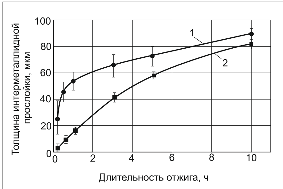
Рисунок 4.21 – Зависимость толщины интерметаллидной прослойки от длительности отжига сваренного взрывом «Ni – Al» композита при температуре 620 °C. 1 – средняя толщина прослоек в образце, полученном сваркой взрывом, 2 – средняя толщина прослоек в образце, полученном путем заливки алюминия в зазоры между пластинами никеля
