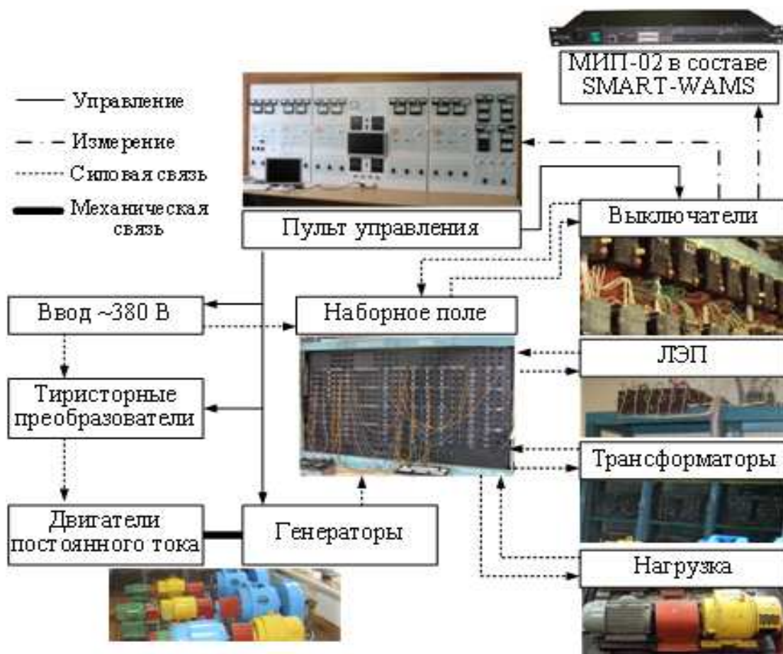
Рисунок 4.2. Основное оборудование ЭДМ, использованное в эксперименте
