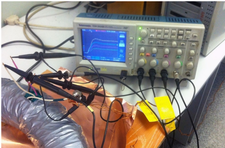
Рисунок 3.7 – Регистрация сигналов в центральной части витка и обкладок
