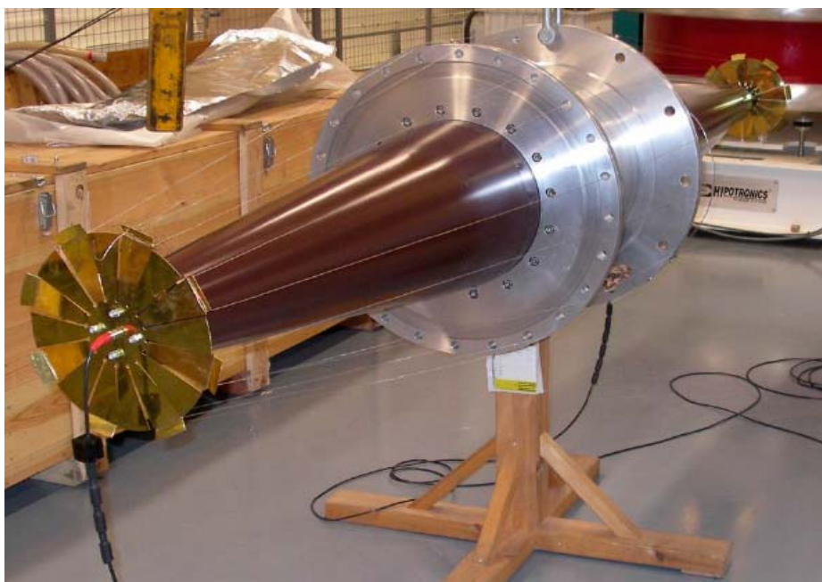
Рисунок 1.18 – Лабораторные измерения свойств ввода 220 кВ
