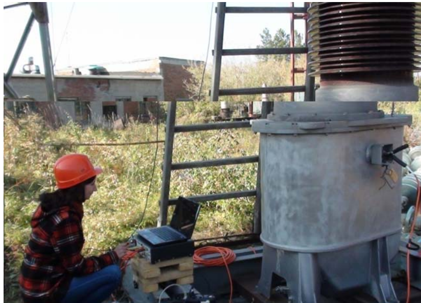
Рисунок 4.1 – Измерение диэлектрических характеристик трансформатора тока
