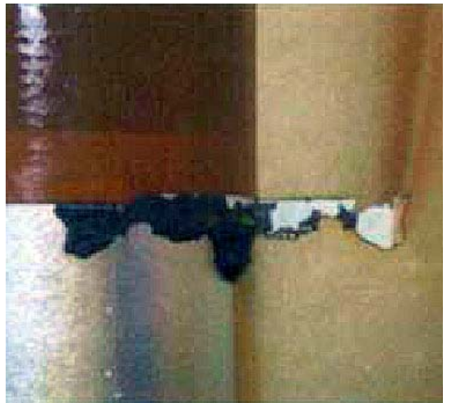
Рисунок 1.30 – Изменение концентраций газов, растворенных в масле (а) и вызвавшее его повреждение изоляции на краю выравнивающей обкладки (б)
