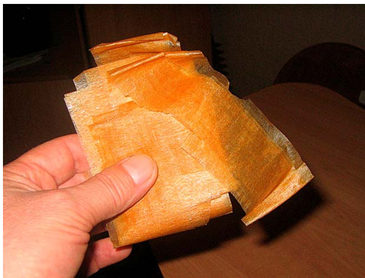
Рисунок 4.6 – Бумажная изоляция первичной обмотки, пропитанная маслом и местами «склеенная» X-воском
