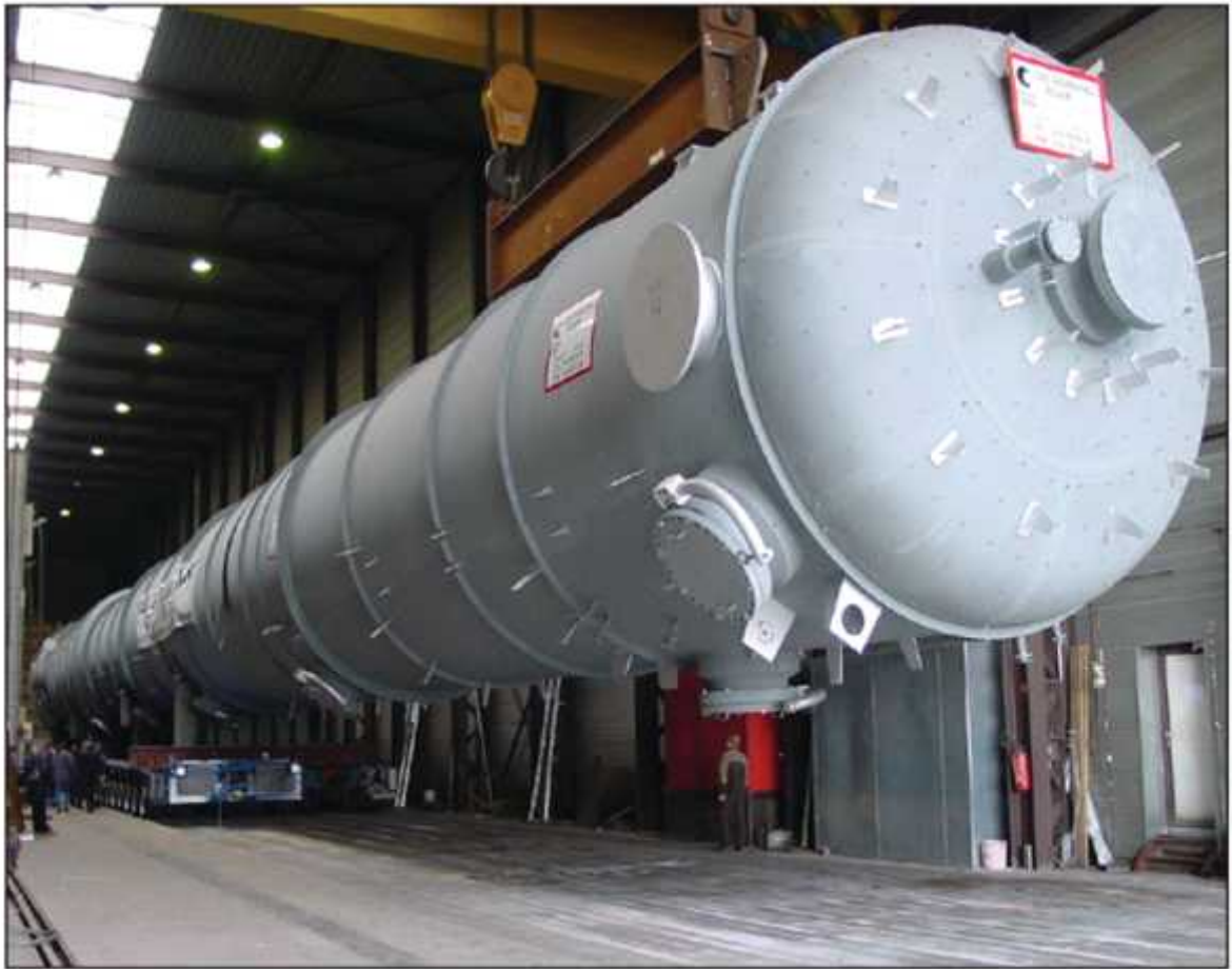
Рисунок 6.1 – Титановая колонна, плакированная сталью. Диаметр конструкции около 5 м, вес 450 тонн [166]
