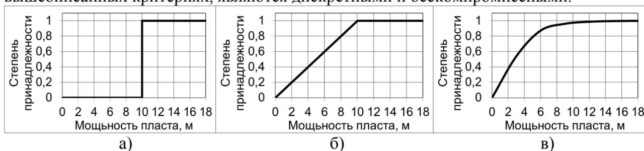
Рисунок 1 – Переход от четкой логики оценки к нечеткой: а) характеристическая функция обычного множества; б) кусочно-линейная функция нечеткого множества ( $S$ -типа); в) нелинейная функция принадлежности нечеткого множества ( $S$ -типа).
