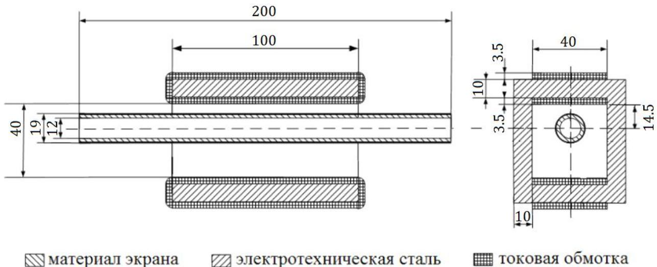
Рис. 3.1. Схема конструкции магнита: проекции в плоскостях ZY (слева) и XY (справа). Размеры указаны в миллиметрах
